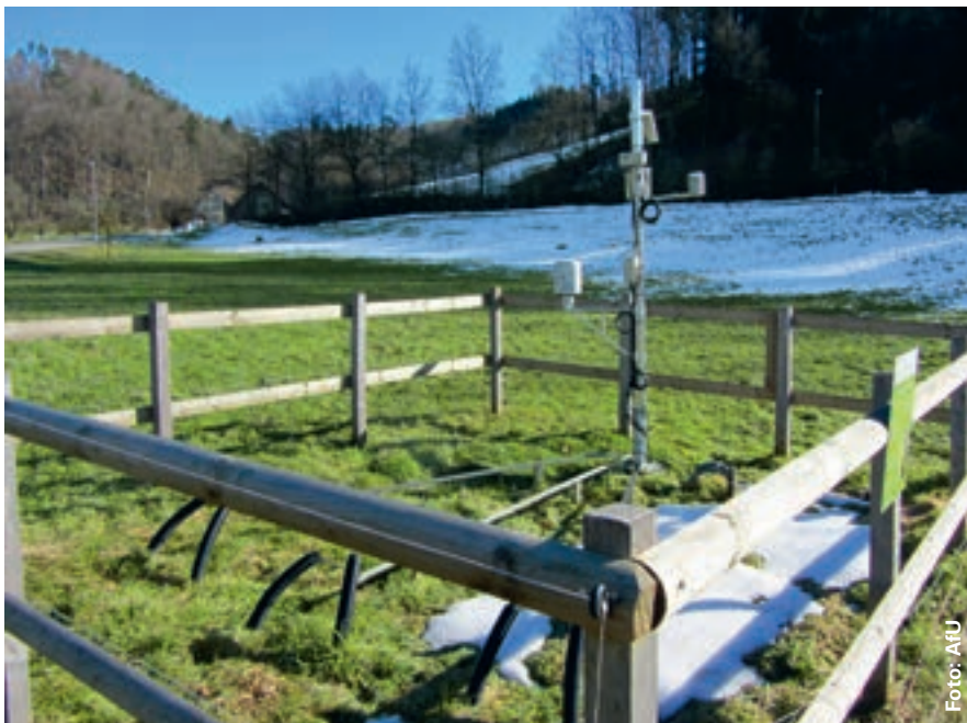
Bodenmessstation Gränichen-Liebegg Mitte Februar 2015: Die Tensiometer erfüllten auch die Anforderungen an einen Winterbetrieb problemlos. Rechts ist die Informationstafel am Zaun ersichtlic.
