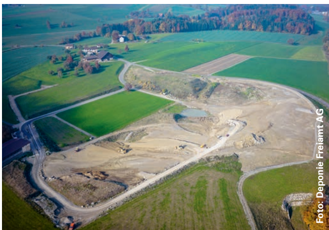
Deponie Weid-Banacker mit offener Deponiefläche in der Bildmitte. Direkt dahinter angrenzend befindet sich die bereits seit Längerem aufgefüllte und fertig rekultivierte Deponie Feld, deren Rekultivierungsböden wieder uneingeschränkt landwirtschaftlich genutzt werden können.
