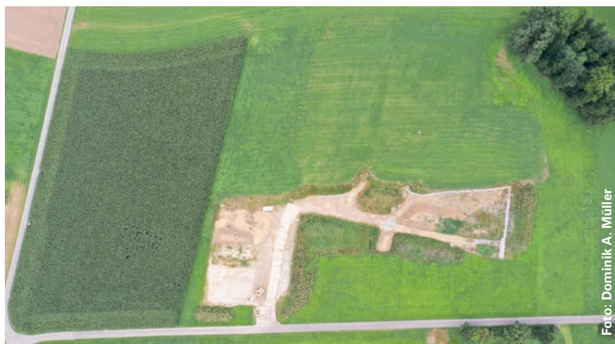
Aristau: In der Bildmitte ist der Mitte August noch offene respektive noch nicht fertiggestellte Bereich zu sehen. Neben den Bodendepots (erkennbar an der dunkleren Vegetation rings um die offene Fläche) ist die Erschliessung mittels Baggermatratzenpiste gut erkennbar. Oberhalb und unterhalb des offenen Bereichs sind die in den Jahren 2017 bis 2019 fertiggestellten Bereiche sichtbar. Der linke Bereich der Aufschüttung konnte in diesem Jahr zur uneingeschränkten landwirtschaftlichen Nachnutzung (momentan für Maiswirtschaft) freigegeben werden.
