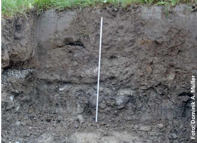
Fertiger Rekultivierungsboden mit 30 Zentimeter Ober- und 50 Zentimeter Unterboden. Unten ist die Rohplanie sichtbar.
