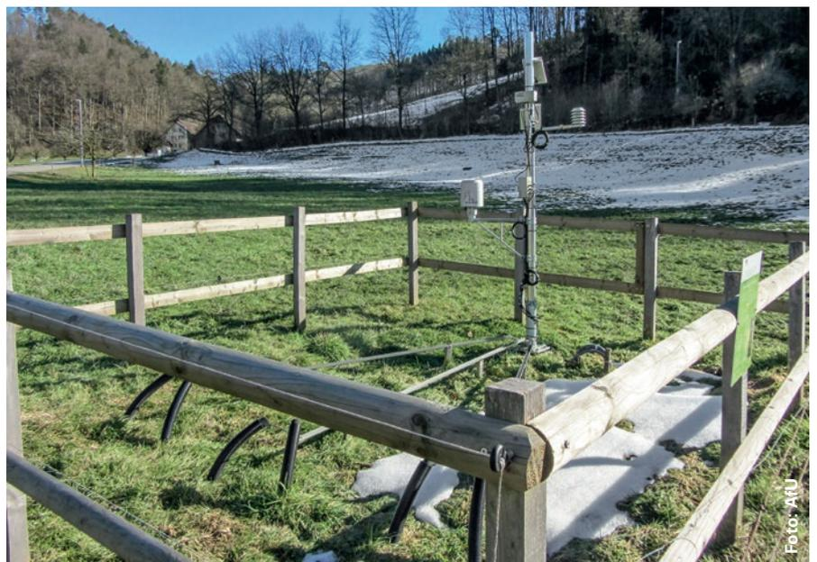
In unmittelbarer Nähe zum KABO-Standort Gränichen befindet sich auch die Bodenfeuchtemessstation: Mast mit Solarpanel, Regen-, Temperatur- und Luftfeuchtemesser sowie Datalogger und Übertragungseinheit. Vom Mast weg führen in drei Schienen die Kabel zu den 6 Tensiometern. Am Ende jeder Schiene misst ein Tensiometer in 20 und 35 cm Bodentiefe die Feuchte.
