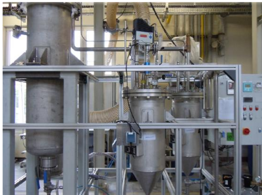
Abbildung 8 Budenheim Carbonic Acid Process Laboranlage (Extraktionsvolumen 100 l) der Chemischen Fabrik Budenheim KG [23].
