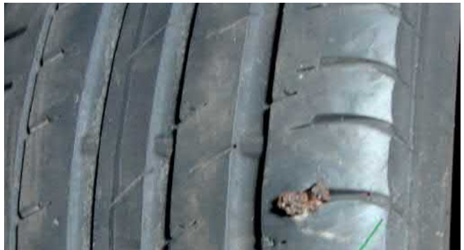
Kleinere Verletzung, mit Dichtmittel repariert.
