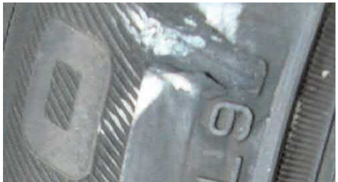
Kleine Schrammen, Stahlchord und Abdecklage nicht sichtbar.
