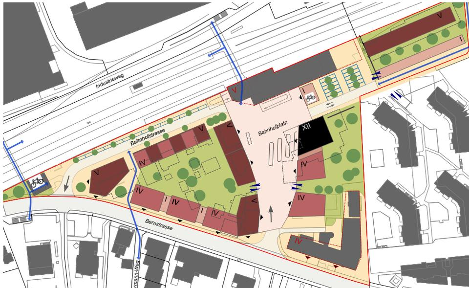
Bebauungskonzept: Die bessere Fassung und Markierung der Strassen- und Freiräume wird durch die Bebauungsstruktur gewährleistet. Die dichte und lärmschützende Bebauung ermöglicht klar differenzierte Freiräume. Eine Unterteilung in Etappen wird zudem vorgegeben.
