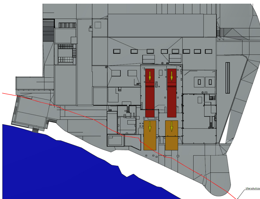
Abbildung 27: Aufstellung Feuerung & Kessel und Elektrofilter Variante 4
