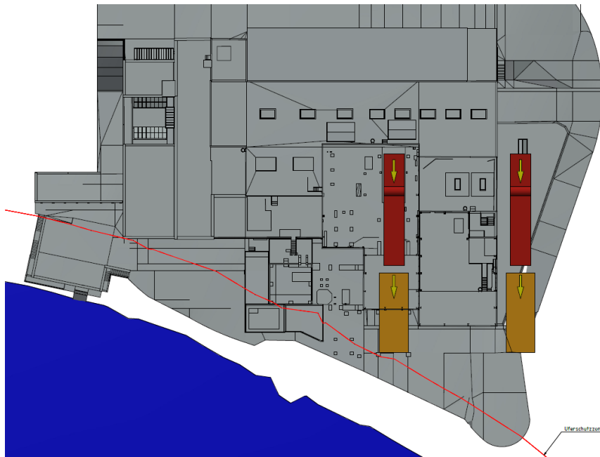
Abbildung 26: Aufstellung Feuerung & Kessel und Elektrofilter Variante 3
