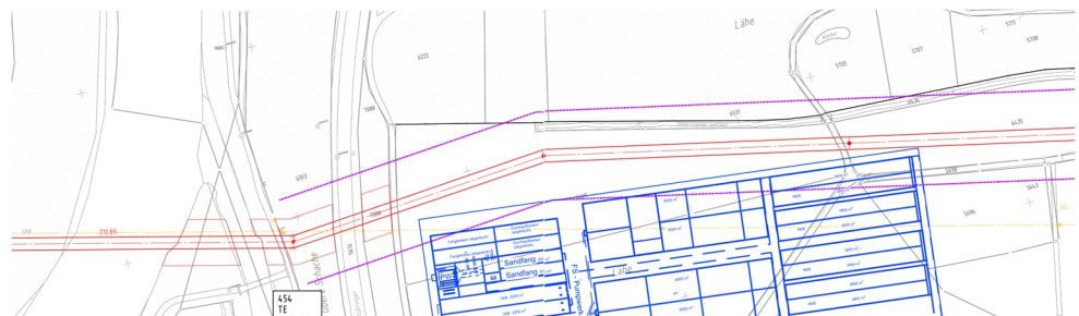
Abb. 35: Neue Linienführung der 132 kV-Übertragungsleitung (Quelle: AXPO)
