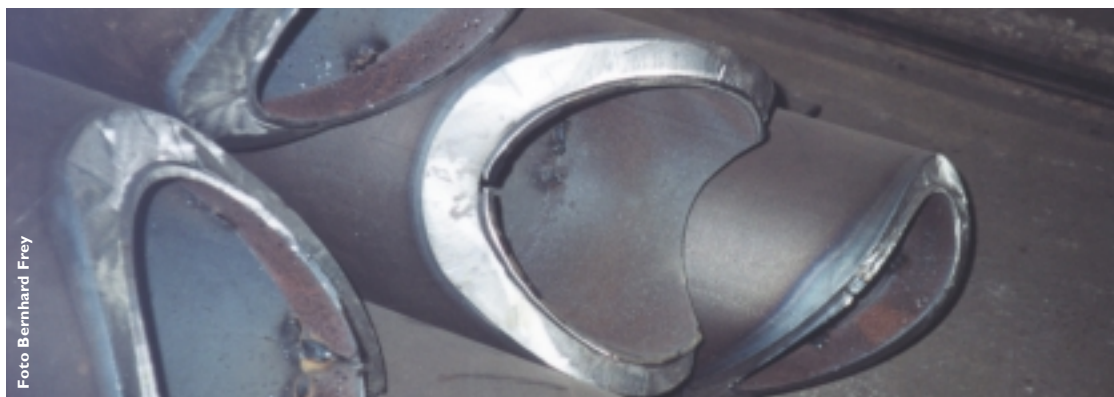
Die Rohre wurden von einer computergesteuerten Brennschneidmaschine zugeschnitten
