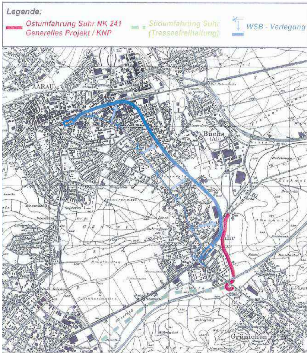
So sah man es 2002: die Ostumfahrung Suhr (rot, generelles Projekt) und die WSB-Verlegung (blau, realisiert).
