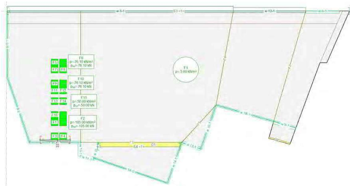
Abb. 31: Schnitt C; Massgebende Laststellung (vereinfacht, gedreht), Resultierende Schnittkraft Querkraft
