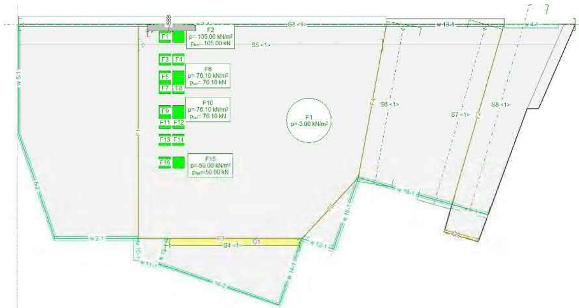
Abb. 34: Schnitt A; Massgebende Laststellung (vereinfacht, gedreht), Resultierende Schnittkraft Querkraft
