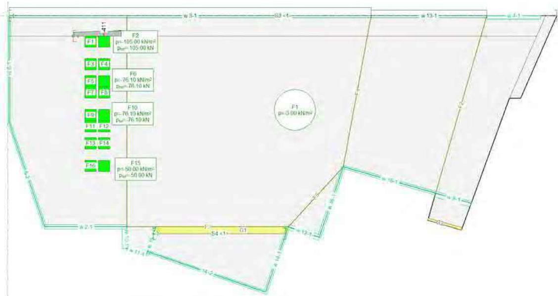
Abb. 30: Schnitt B; Massgebende Laststellung (vereinfacht, gedreht), Resultierende Schnittkraft Querkraft
