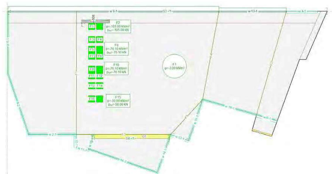
Abb. 35: Schnitt B; Massgebende Laststellung (vereinfacht, gedreht), Resultierende Schnittkraft Querkraft
