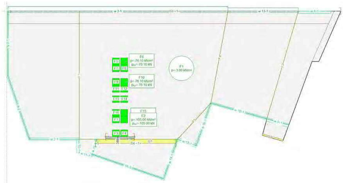
Abb. 36: Schnitt C; Massgebende Laststellung (vereinfacht, gedreht), Resultierende Schnittkraft Querkraft
