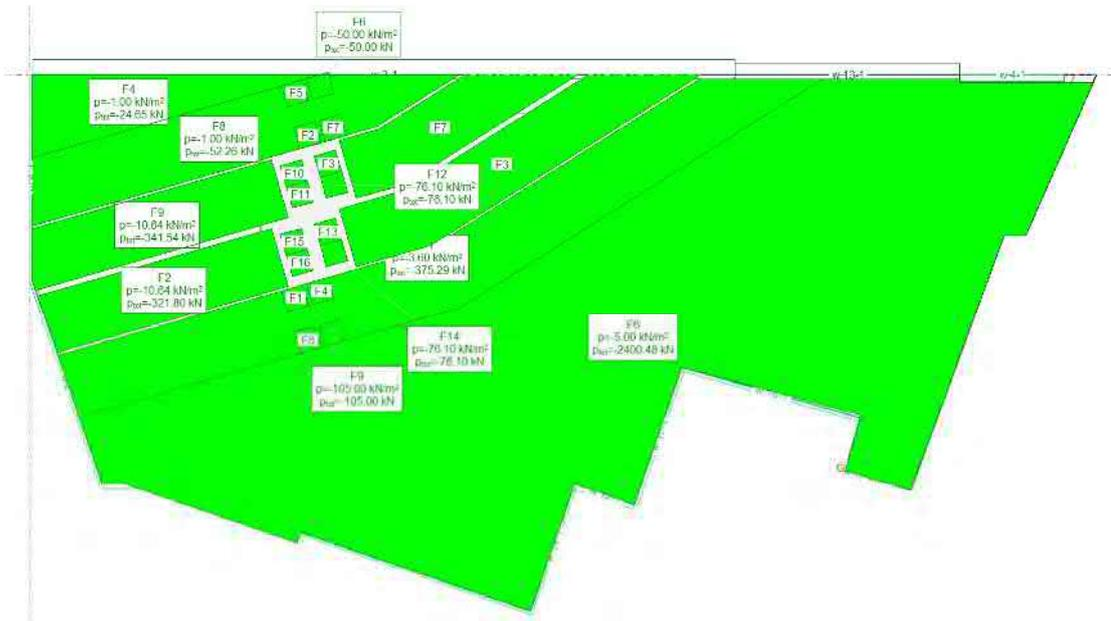
Abb. 32: Massgebende Laststellung Biegung Feld 2 mit LM 1 (Strasse) und LM 4 (Strassenbahn)
