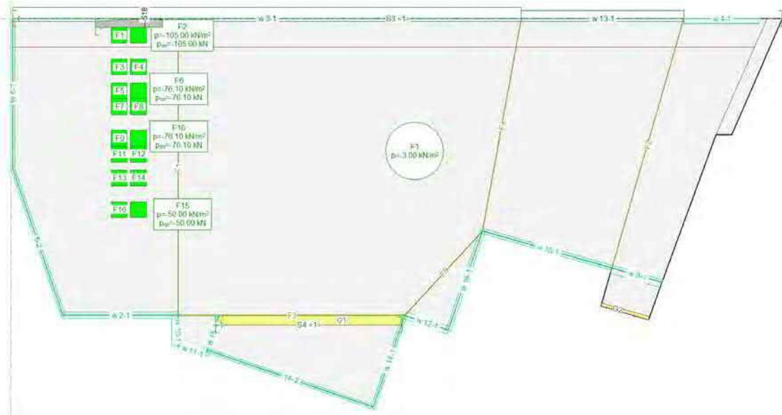
Abb. 29: Schnitt A; Massgebende Laststellung (vereinfacht, gedreht), Resultierende Schnittkraft Querkraft
