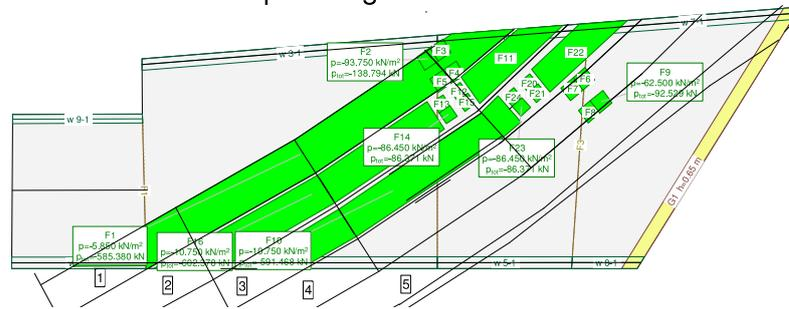
Abb. 41: massgebende Laststellung Querkraft R.pr. II Seite Gstühl (L.S. XIII, TRG 1,4)
