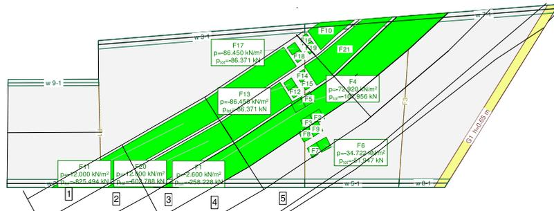
Abb. 39: massgebende Laststellung mit abgeminderten Beiwerten gemäss SIA 269 (L.S. IX, TRG 3,4)
