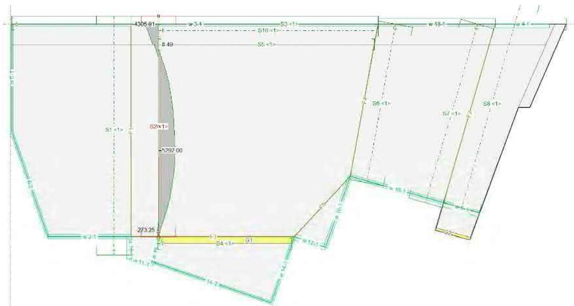
Abb. 33: Resultierende Schnittkräfte Biegung (Balkenschnitt Breite = 3m)
