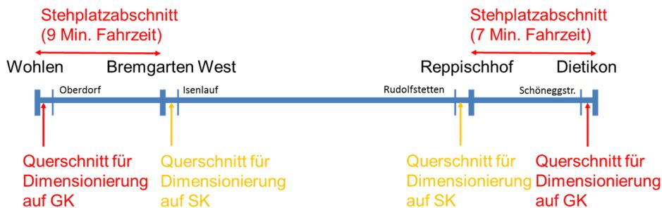
Abbildung 7 Massgebende Querschnitte am Beispiel der BDWM
