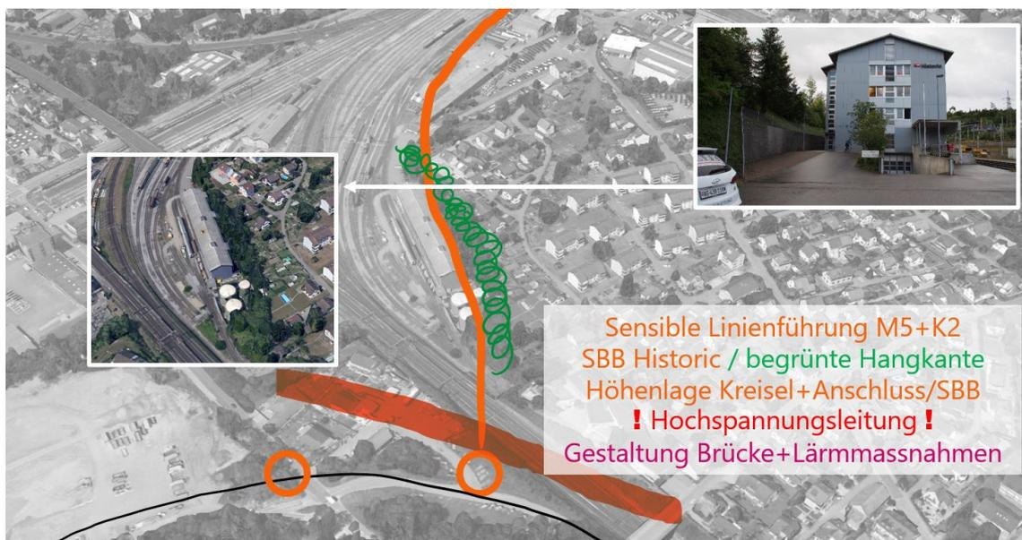
Abbildung 22: Anbindung an Südwestumfahrung und Trassierung im Umfeld SBB
