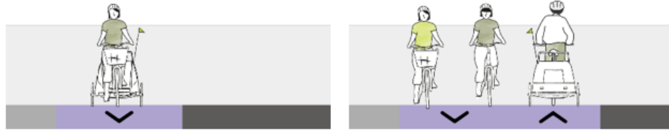
Beispielquerschnitte Einrichtungsweg, Zweirichtungsweg
