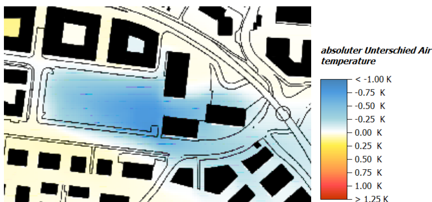
Abbildung 8: Lufttemperaturunterschied im Zielzustand aufgrund der Umgestaltung des Schadenmühleplatzes zu einer Grünanlage mit ca. 1/3 Baumbedeckung.
