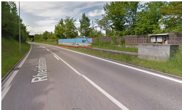
Abbildung 16 Skizze Stützmauer Zurzach: unbegrünter Abschnitt mit Skizze PV Module (abgebildet: Option Anbringung mit Neigungswinkel 80°)
