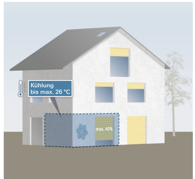
Maximaler Glasanteil ohne Verschattung von Balkonen (eine Fassade mit Fenster)
