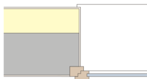
Abb. 2 Falsch: Ohne Dämmung der Leibung
