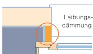
Mit dem Ersatz der Fenster sind die Laibungen mit mindestens 2 cm – oder besser mehr – zu dämmen. Ist dies nicht sofort möglich, sollte das Fensterlichtmass so geplant werden, dass eine spätere Fassadendämmung dies zulässt.
