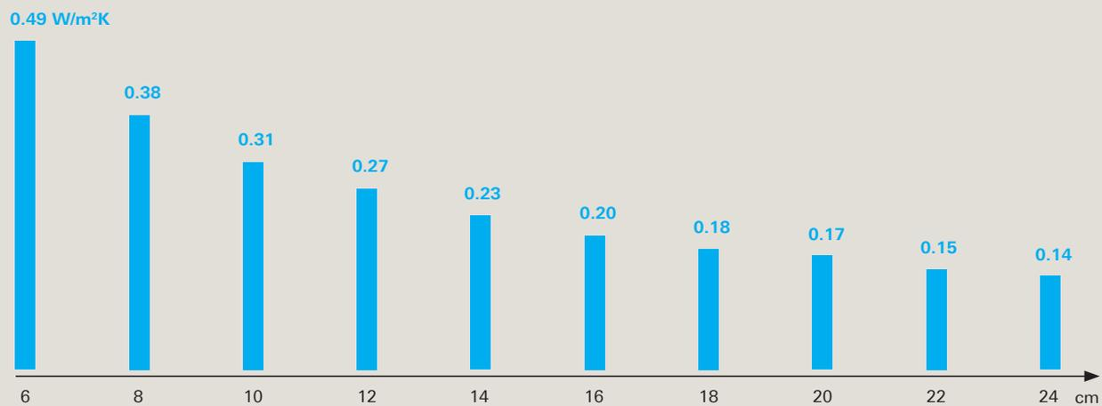
Dämmen mit einem gut isolierenden Material ist eine wirkungsvolle Modernisierungsmassnahme. Die Grafik zeigt, welchen Einfluss die Dämmstärke auf den U-Wert einer Mauer hat (Annahme: Mauerwerk  $U=2.5 \text{ W/m}^2\text{K}$ ). Die Werte sind auch vom gewählten Dämmstoff abhängig.
