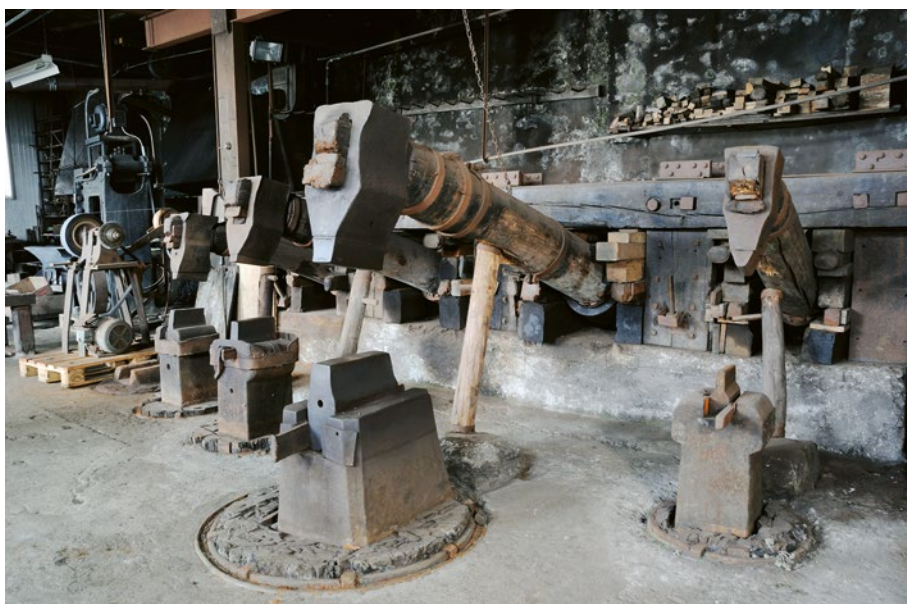
13 Seengen, Hammerschmiede, Teil des Hammerwerks mit Ambossen. Die rund 160 Jahre alte, mit Wasserkraft betriebene Hammerschmiede ist ein herausragendes technikgeschichtliches Zeugnis (Foto: © Kantonale Denkmalpflege Aargau, Christine Seiler, 2016).
