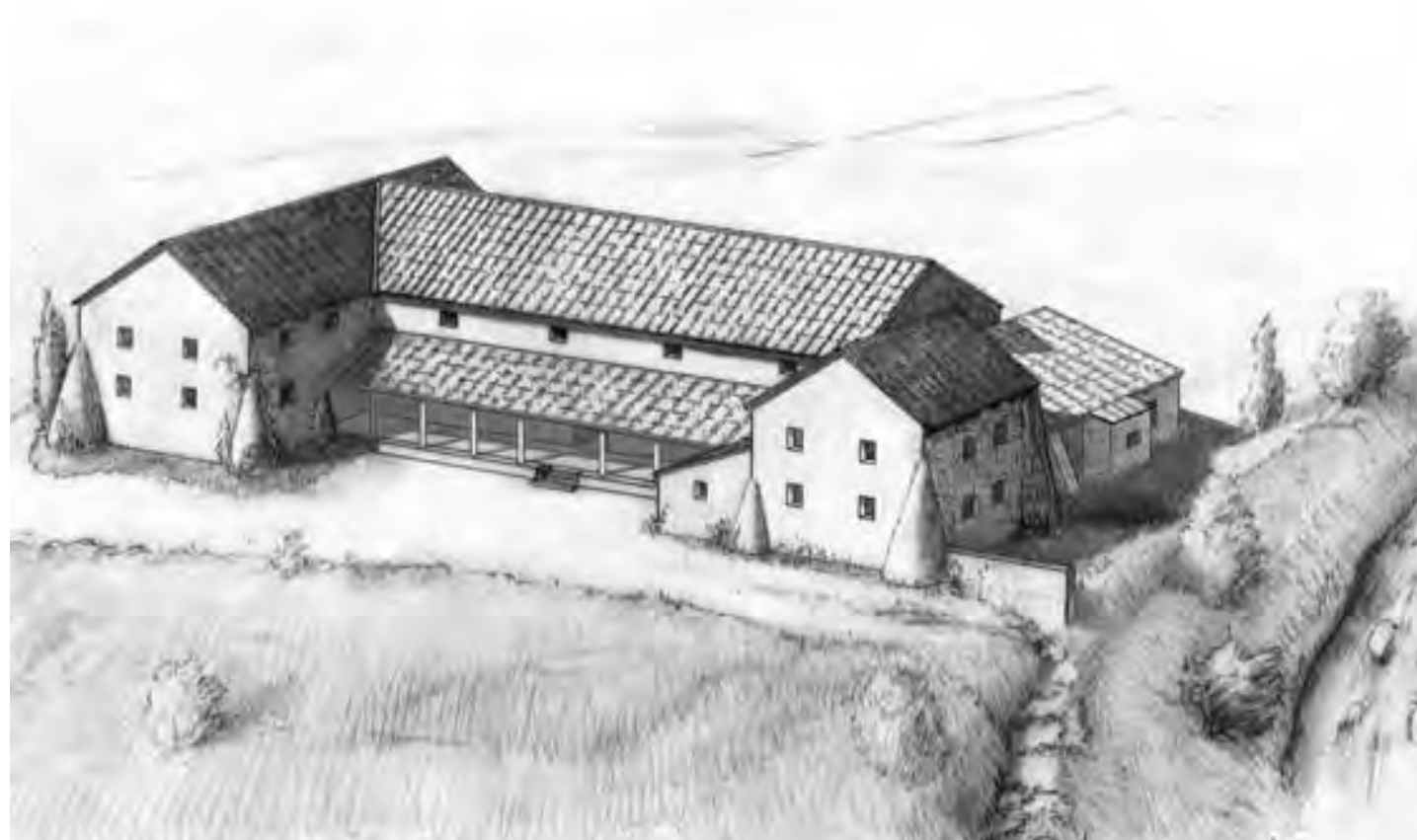
Rekonstruktion des römischen Herrenhauses von Oberlunkhofen mit dem Menschenbächli. Die breiten Mauerfundamente lassen darauf schliessen, dass das Gebäude mit Ausnahme des Badetraktes zweigeschossig war und einen wettergeschützten Laufgang (Porticus) auf der Frontseite besass. Der Badetrakt auf der Seite zum Menschenbächli wurde im Verlaufe der Zeit mehrmals umgebaut.
