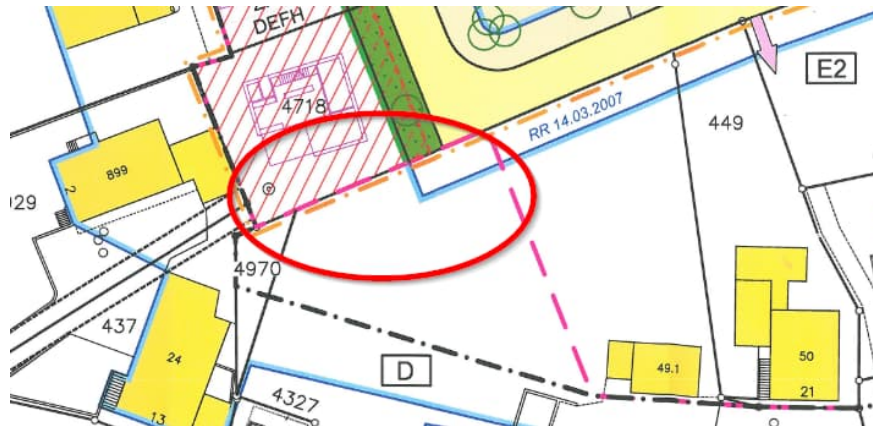
Abbildung 5: Beispiel eines nicht zulässigen geometrischen Versatzes zwischen der orangenen und der pinkfarbenen Linie im Nutzungsplan. Die beiden Linien müssten deckungsleich und parzellenscharf sein.
