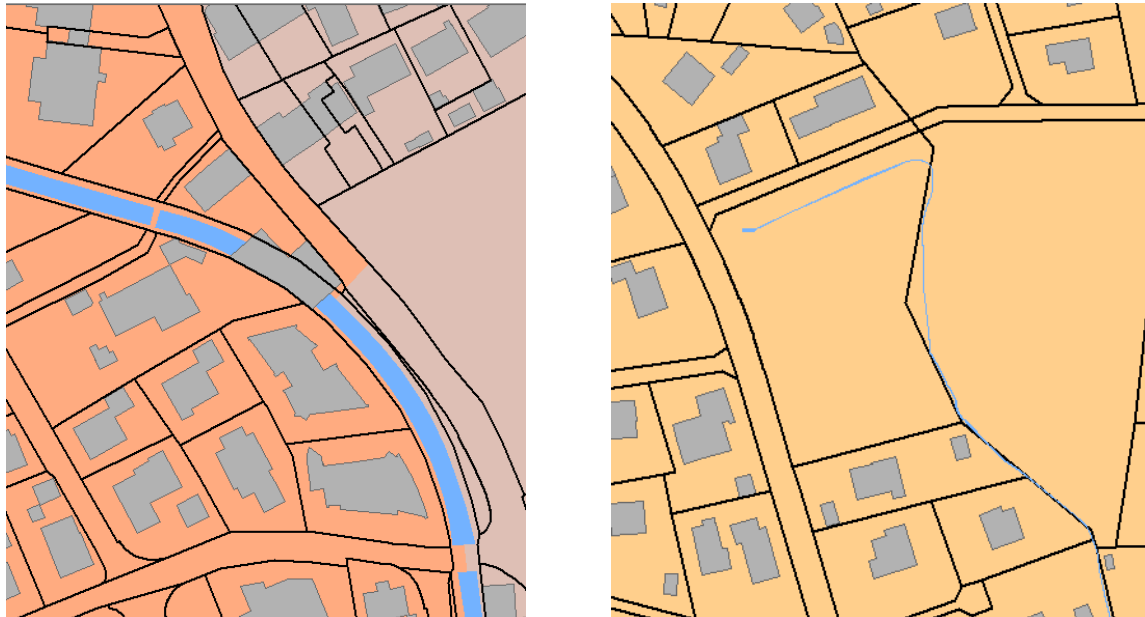
Abbildung 9: Breite Gewässer (links) werden als Fläche mit Code 1629 beziehungsweise 3291 (Orientierungsinhalt) abgebildet und mit der Grundnutzung abgegeben. Schmale Gewässer (rechts) werden als Überlagerung (Linie, Orientierungsinhalt) abgebildet, die Grundnutzung wird durchgehend festgelegt.
