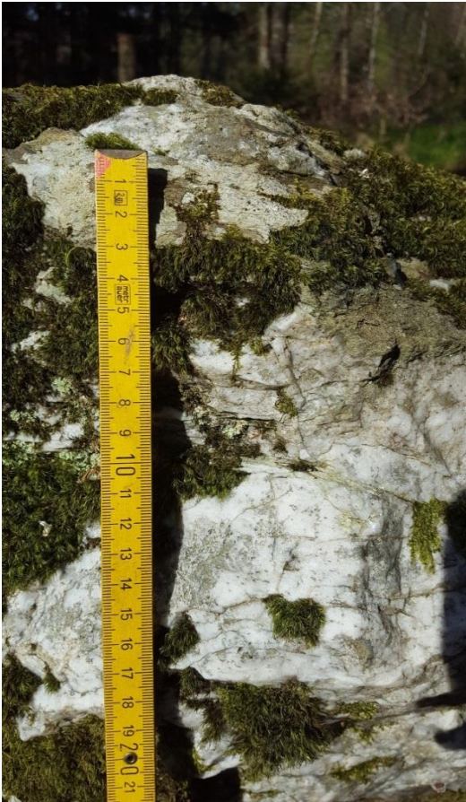
Wechsellagerung des hier weissen Quarzits mit dem bräunlich und grünlich angewitterten Chlorit-Gneis
