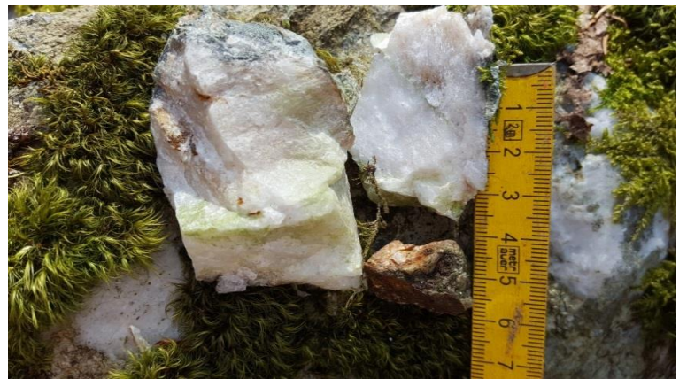
2 aufgeschlagene Quarzitstücke und ein kleines Gneisstück mit rötlicher Anwitterungsfarbe durch Eisenoxidation
