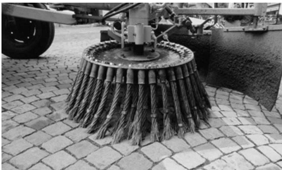
Jätbesen erlauben eine direkte Bekämpfung von Pflanzen am Strassenrand, wo diese nicht toleriert werden können. Mit Stahlseilborsten wird hoher Bewuchs entfernt, beispielsweise vor einer baulichen Sanierung. Foto: Guido Masé, Ökoskop, Gelterkinden.
