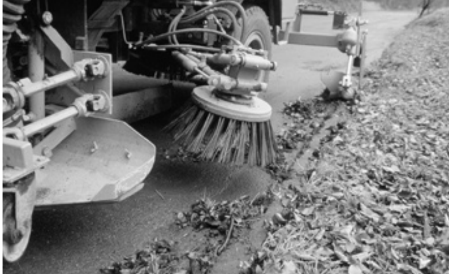
Abbrandflug, montiert an einer Wischmaschine. Im Normalfall wird alle 5 Jahre abgerandet. Foto: Guido Masé, Ökoskop, Gelterkinden.
