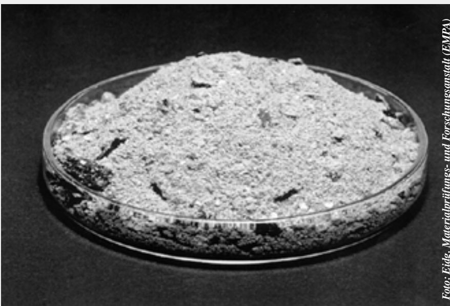
EMPA-Ascheschnelltest: Zink-Messung mit «Zink-Set»
