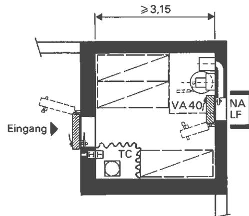
Figur 2.4-4 Grundrissform für 9 Schutzplätze (Bodenfläche  $\geq 10 \text{ m}^2$ )
