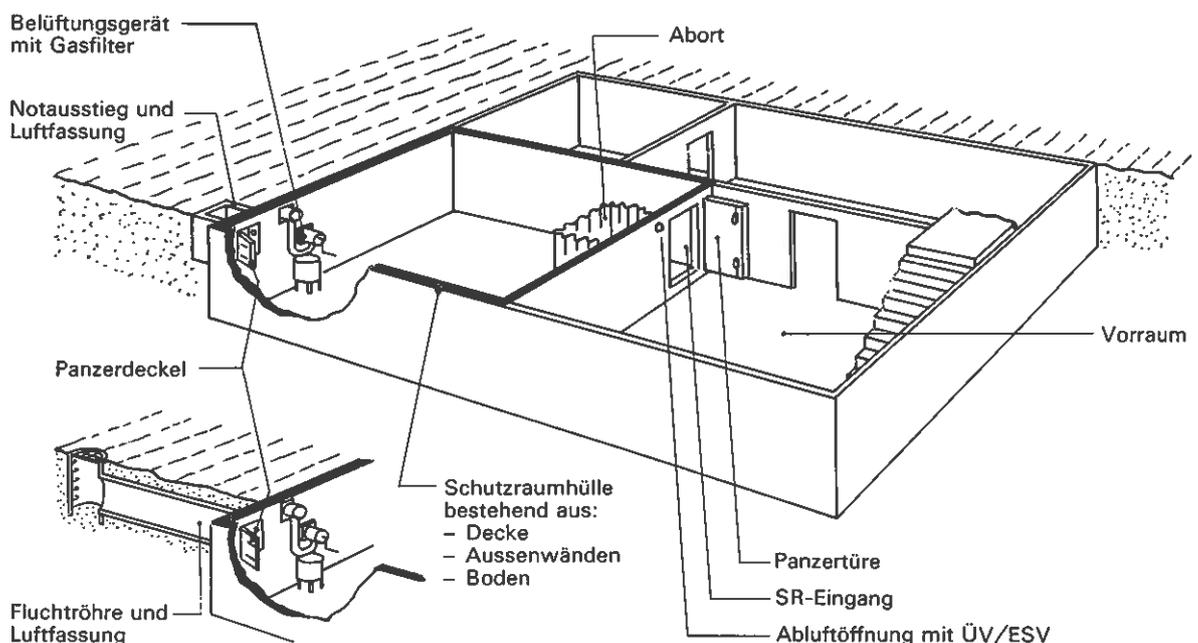
Figur 1.1-1 Schutzraum mit maximal 50 Schutzplätzen
