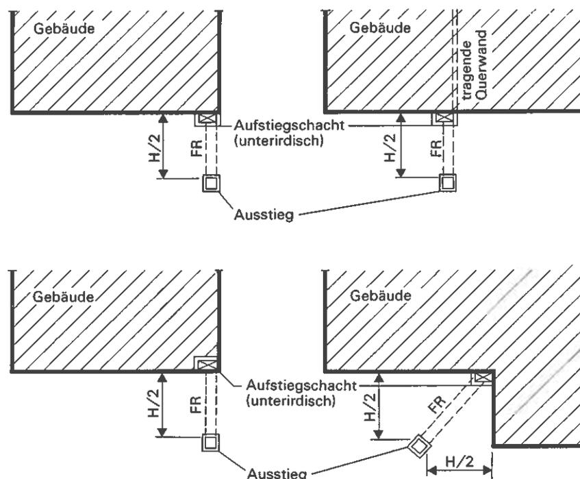
Figur 2.7-6 Anordnung des Aufstiegschachtes bei tiefliegenden Schutzräumen (Grundriss)
