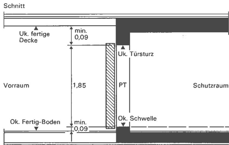
Figur 2.6-7 Einbaumasse der Panzertüren im Vertikalschnitt (Minimalmasse)
