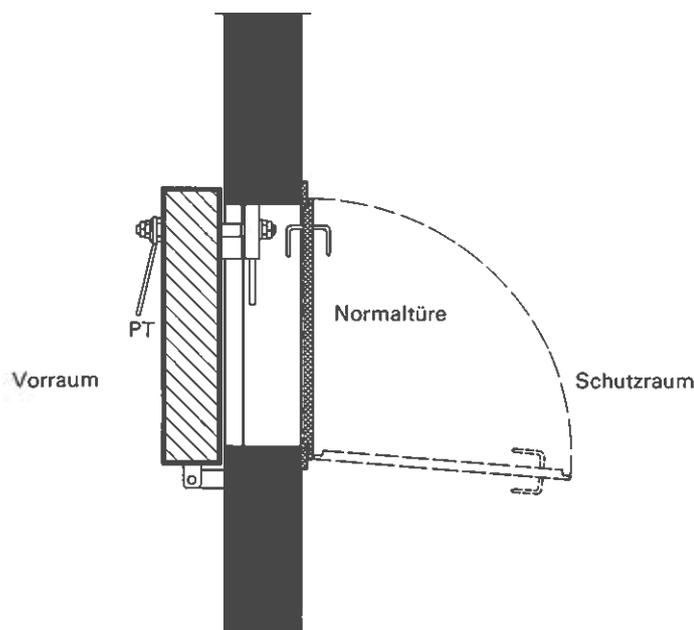
Figur 2.6-8 Anordnung einer Normaltüre bei einer Panzertüre (Grundriss)
