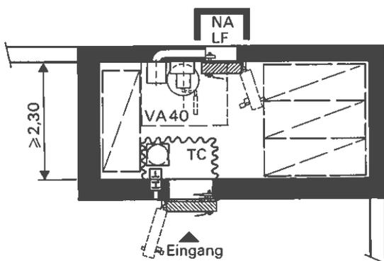
Figur 2.4-5 Grundrissform für 10 Schutzplätze (Bodenfläche  $\geq 11 \text{ m}^2$ )
