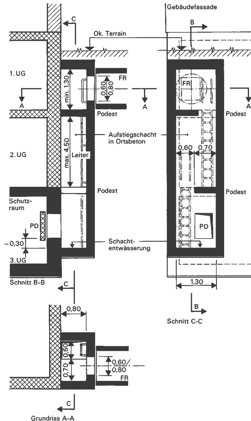
Figur 2.7-7 Gestaltung von Ausstiegen aus tiefliegenden Schutzräumen
