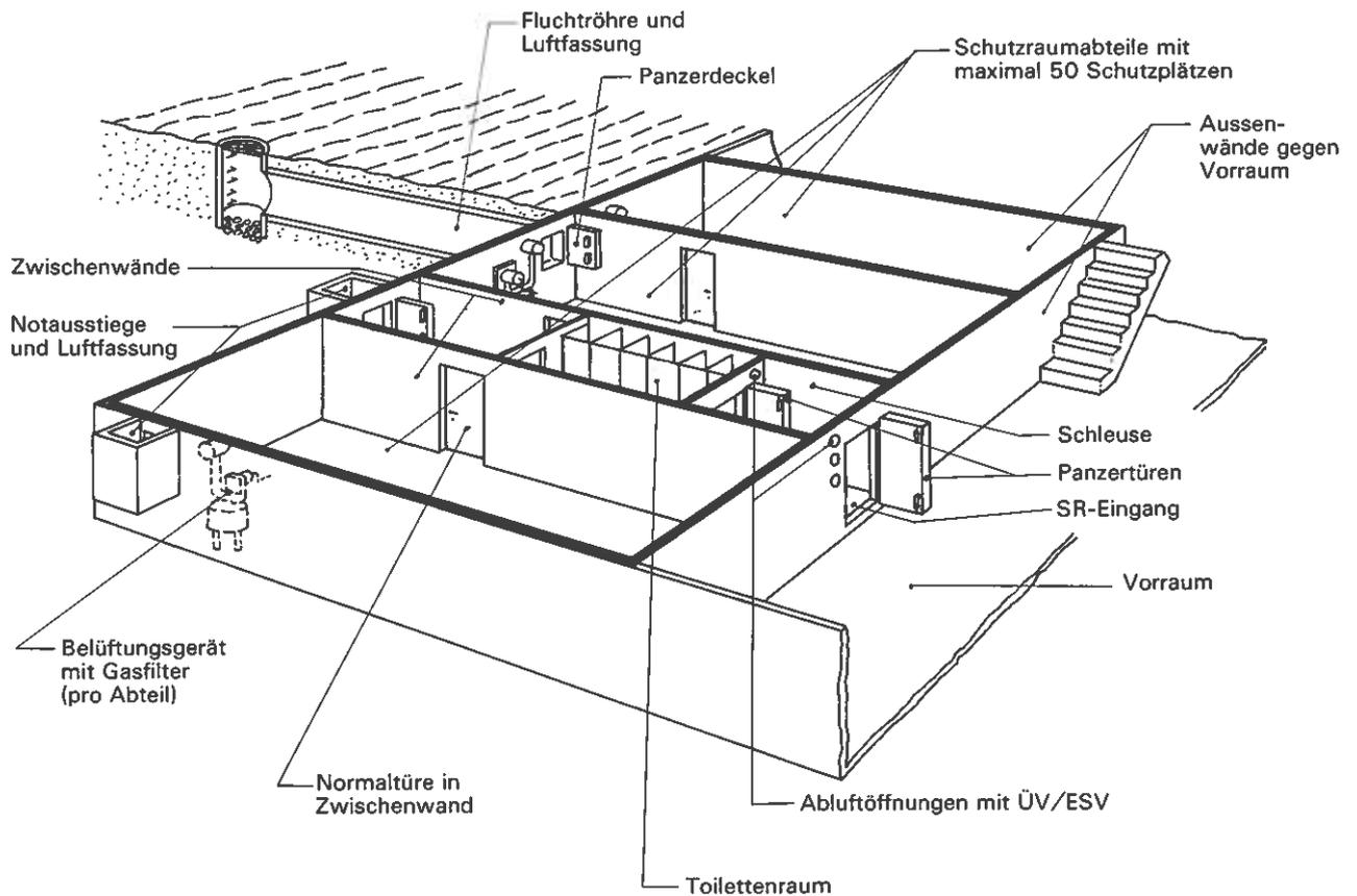
Figur 1.1-3 Schutzraum mit 101 bis 200 Schutzplätzen
