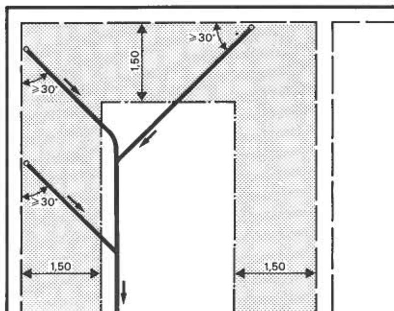
Figur 3.4-1 Anordnung von Ablaufleitungen in der Schutzraumdecke
