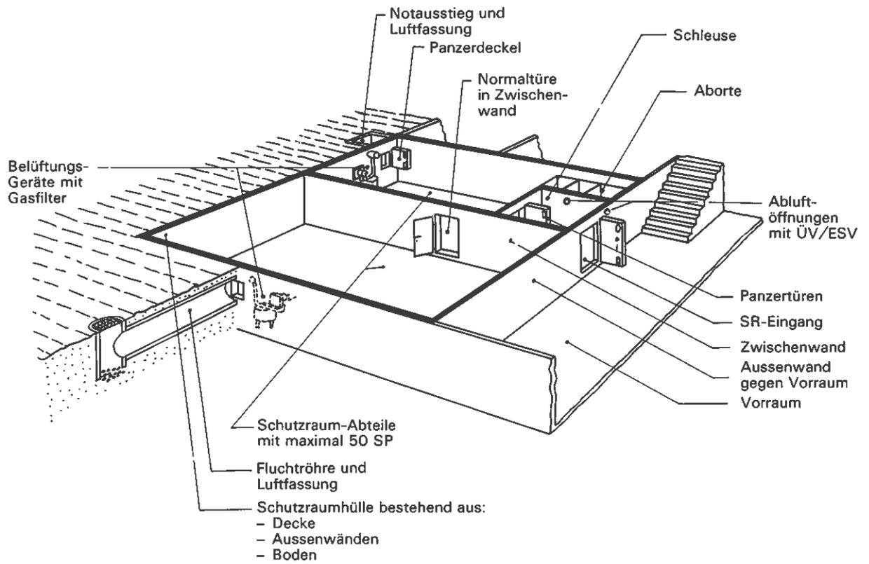
Figur 1.1-2 Schutzraum mit 51 bis 100 Schutzplätzen
