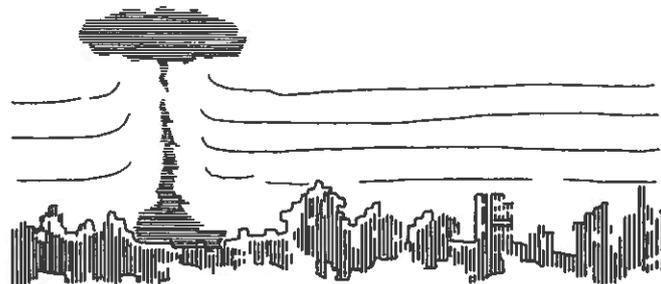
Die Druckwelle der Explosion erreicht den Schutzraum nach einigen Sekunden. Mit ihrem Eintreffen setzt ein Wind von der vielfachen Stärke eines Orkans ein. Er dauert gleich lang wie der allseitig wirkende Überdruck, also einige Zehntelsekunden, bei grossen Kalibern einige Sekunden.
