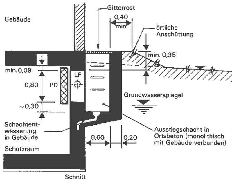
Figur 2.7-5 Notausstieg bei hohem Grundwasserspiegel
