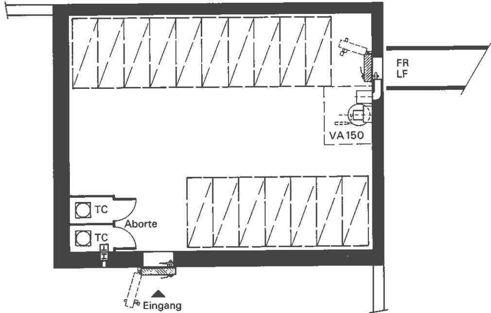
Figur 2.4-11 Grundrissform für 50 Schutzplätze (Bodenfläche  $\geq 53 \text{ m}^2$ )
