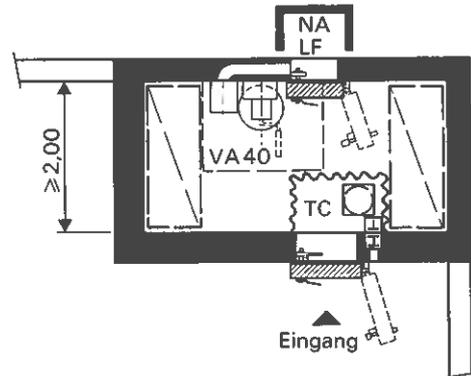
Figur 2.4-2 «Längliche» Grundrissform für 5 bis 7 Schutzplätze (minimale Bodenfläche  $8 \text{ m}^2$ )
