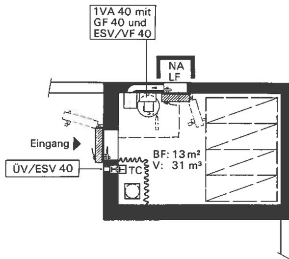
Figur 3.1-4 Belüftungseinrichtungen für einen Schutzraum mit 12 Schutzplätzen
