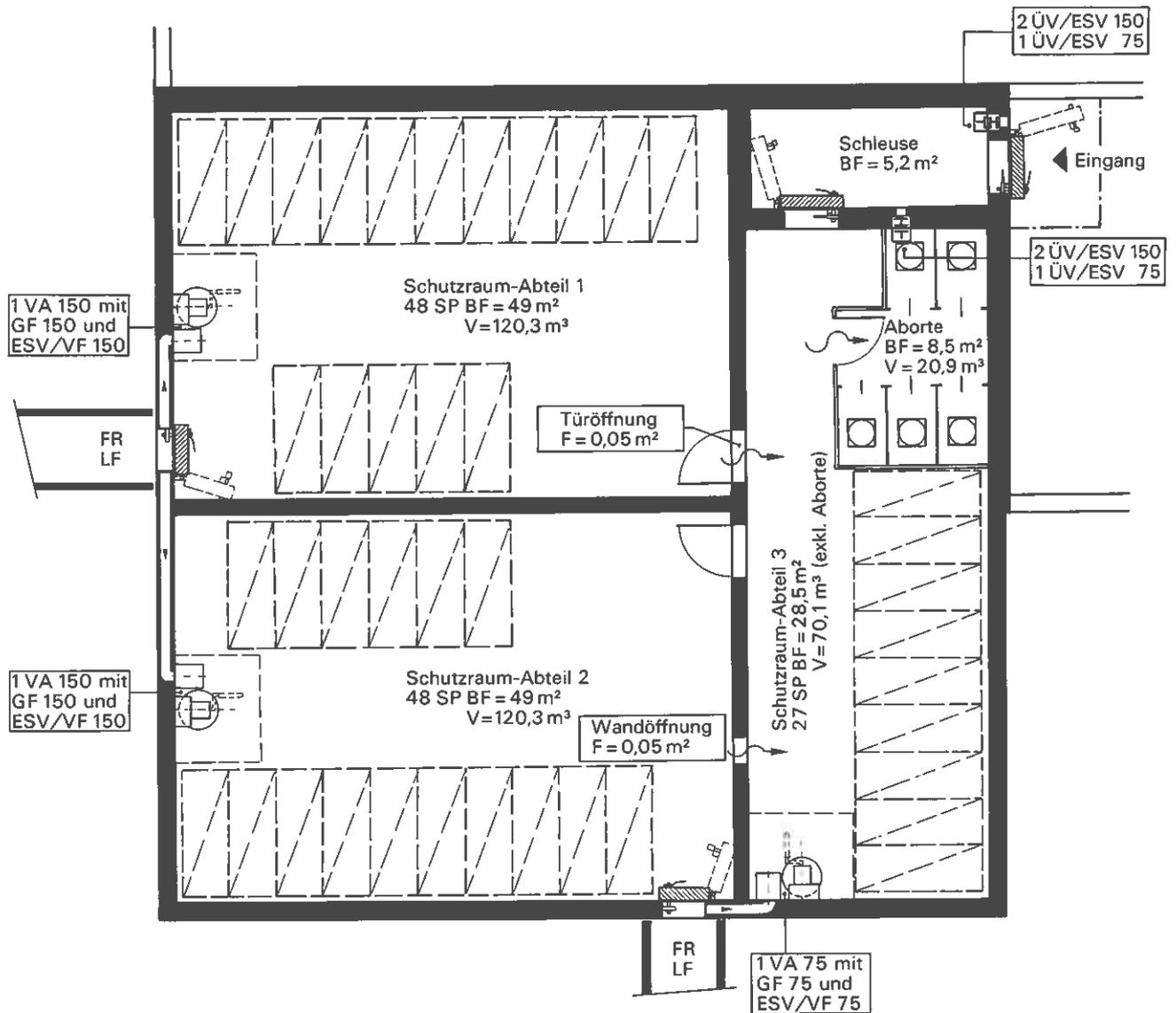
Figur 3.1-5 Belüftungseinrichtungen für einen Schutzraum mit 123 Schutzplätzen
