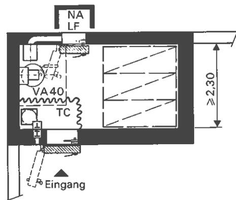
Figur 2.4-3 Grundrissform für 8 Schutzplätze (Bodenfläche  $\geq 9 \text{ m}^2$ )
