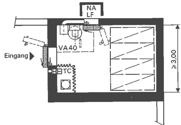
Figur 2.4-6 Grundrissform für 12 Schutzplätze (Bodenfläche  $\geq 13 \text{ m}^2$ )
